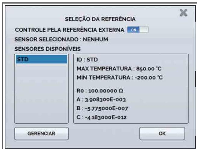
Os banhos térmicos TA são fornecidos com uma entrada para sensor de referência externo que pode ser usado para melhorar a exatidão, eliminando o desvio e o efeito de carregamento nos inserts sólidos ou para trabalhar com o insert específico de líquido agitado, insert de corpo negro ou insert sanitário.
