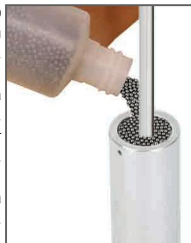
Com ambos é possível calibrar sensores de temperatura que apresentam forma irregular ou cujas dimensões não coincidam com os furos disponíveis no insert.
