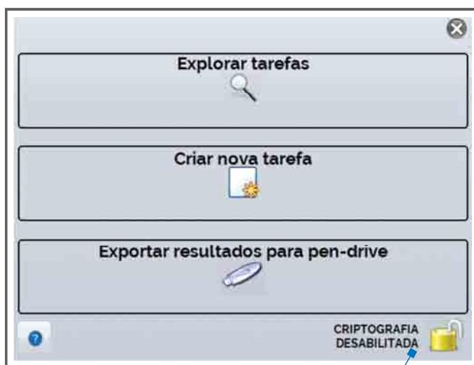
A comunicação com o software de calibração e também com o software ISOPLAN da Presys é criptografada para segurança da integridade dos dados de calibração em conformidade com o FDA 21 CFR Part 11. Quando ativado pelo administrador, o arquivo XML com os dados da calibração será criptografado.
